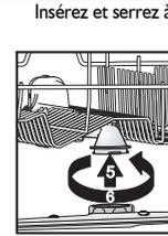
Insérez et serrez à fond les bras d'aspersion supérieur et inférieur.
