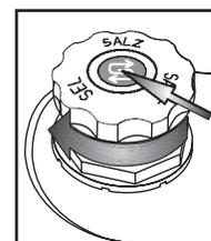
Vissez le bouchon. Éliminez les résidus de sel autour du bouchon. Certains réservoirs à sel possèdent un indicateur de niveau intégré dans le bouchon (reportez-vous à la méthode de contrôle ci-dessous).
