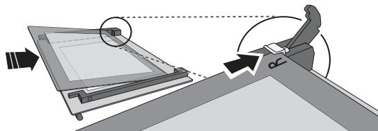
Rimontare il profilo superiore: un clic indica il corretto posizionamento. Verificare che la tenuta sia salda prima di rimontare la porta.
