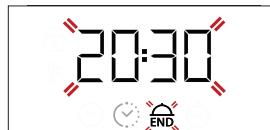
Utilice **+ o -** para ajustar el tiempo deseado de finalización de la cocción y pulse **▷** para confirmar.
