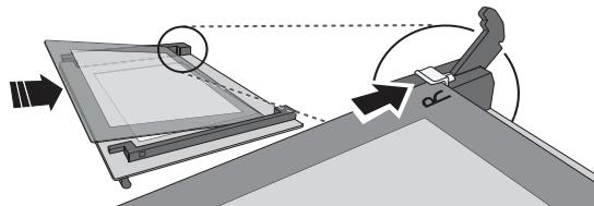
Replacez le bord supérieur : un déclic indique le positionnement correct. Assurez-vous que le joint est bien placé avant de replacer la porte.
