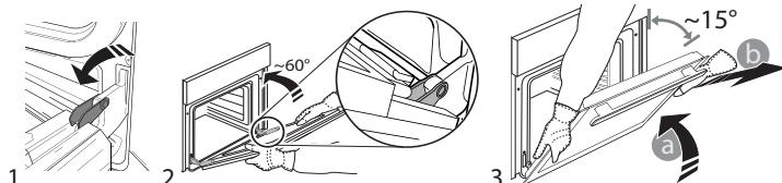
Coloque a porta de parte, apoiando-a sobre uma superfície suave. Reponha a porta, deslocando-a na direção do forno e alinhando os ganchos das dobradiças com os respetivos suportes, fixando a parte superior aos suportes. Baixe a porta e, em seguida, abra-a totalmente. Baixe as linguetas para a respetiva posição original: assegure-se de que as baixa totalmente. Tente fechar a porta e assegure-se de que está alinhada com o painel de controlo. Se não estiver, repita os procedimentos acima.
