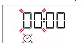
Utilisez + ou — pour régler l'heure et appuyez sur ⌂ pour confirmer. Les deux chiffres des minutes clignotent. Utilisez + ou — pour régler les minutes et appuyez sur ⌂ pour confirmer.
