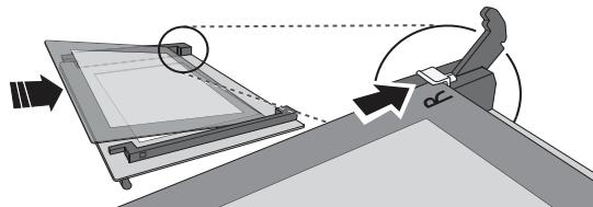
Instale novamente a extremidade superior: irá ouvir um clique, indicando que está bem posicionado. Certifique-se de que a vedação está segura antes de montar novamente a porta.
