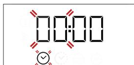
Utilice **+ o -** para ajustar la hora y pulse **⌚** para confirmar. Los dos dígitos de los minutos empezarán a parpadear. Utilice **+ o -** para ajustar los minutos y pulse **⌚** para confirmar.Nota: Cuando el icono **⌚** parpadee, por ejemplo, después de un corte de suministro prolongado, tendrá que volver a configurar la hora.
