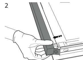
Sollevarre e prendere saldamente il vetro interno con due mani, rimuoverlo e appoggiarlo su un piano morbido prima di eseguire la pulizia.
