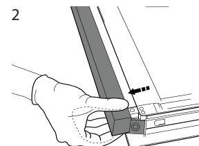
Levante e segure firmemente o vidro interior com ambas as mãos, removendo-o e colocando-o sobre uma superfície suave antes de proceder à sua limpeza.
