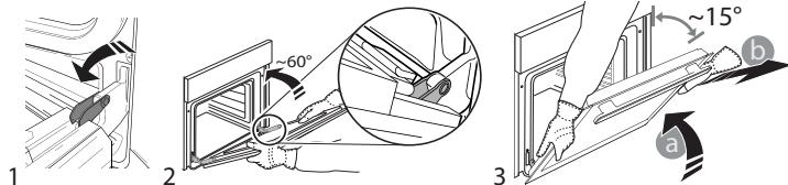
Ponga la puerta en un lado, apoyada sobre una superficie blanda. Vuelva a instalar la puerta llevándola hacia el horno, alineando los ganchos de las bisagras con sus alojamientos y fijando la parte superior en su alojamiento. Baje la puerta y ábrala por completo. Baje los pestillos a su posición original: asegúrese de haberlos bajado por completo. Intente cerrar la puerta y compruebe que está alineada con el panel de control. Si no lo está, repita los pasos de arriba.
