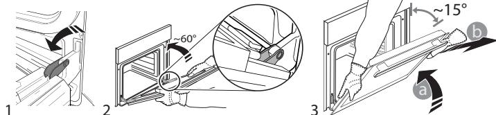
Placez la porte de côté, l'appuyant sur une surface souple. Réinstallez la porte en la plaçant devant le four pour aligner les crochets des charnières avec leurs appuis, et insérez la partie supérieure sur son appui. Abaissez la porte pour ensuite l'ouvrir complètement. Abaissez les loquets dans leur position originale : assurez-vous de les abaisser complètement. Essayez de fermer la porte et assurez-vous qu'elle est alignée avec le panneau de commande. Sinon, répétez les étapes précédentes.
