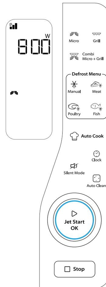
Tato funkce umožňuje spustit funkci Microwave (Mikrovlny) trouby na maximální výkon po dobu 30 sekund. Stiskněte tlačítko Jet Start.
