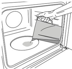
Per avviare la funzione Steam, versare 200 ml di acqua potabile sul fondo del forno. Selezionare la funzione ruotando in senso orario la manopola di selezione sull'icona corrispondente e la manopola del termostato in qualsiasi posizione tra 160 e 180°C (come suggerito dall'icona). La
