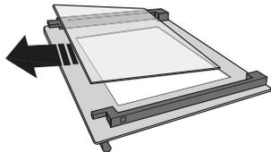
3. Prima di rimontare il vetro interno è necessario riapplicare il vetro intermedio (contrassegnato con "1R"): Per posizionare correttamente i vetri, verificare che la marcatura "R" sia visibile nell'angolo sinistro. Inserire dapprima il lato lungo del vetro contrassegnato con "R" nelle sedi di sostegno, quindi abbassarlo in posizione. Ripetere la procedura per entrambi i vetri.
