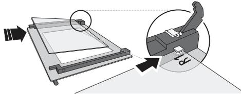
4. Rimontare il profilo superiore: Un clic indicherà il posizionamento corretto. Verificare che la tenuta sia salda prima di rimontare la porta.
