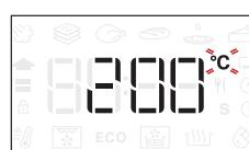
Când pictograma clipește pe afișaj, rotiți butonul pentru modificarea valorii, apoi apăsați pentru confirmare și continuați să modificați următoarele setări (dacă este posibil).
