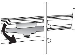
Per fissare la guida, premere la parte inferiore della clip contro la griglia laterale. Assicurarsi che le guide possano scorrere liberamente. Ripetere questa operazione sull'altra griglia laterale, allo stesso livello.
