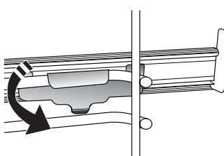
Pentru a fixa ghidajul, apăsați ferm porțiunea inferioară a clemei spre ghidajul pentru grătar. Asigurați-vă că șinele se pot deplasa liber. Repetați acești pași și pentru celălalt ghidaj pentru grătar de la același nivel.
