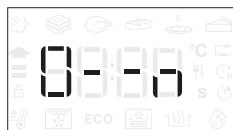
Pentru a debloca tastatura, efectuați aceeași procedură.
