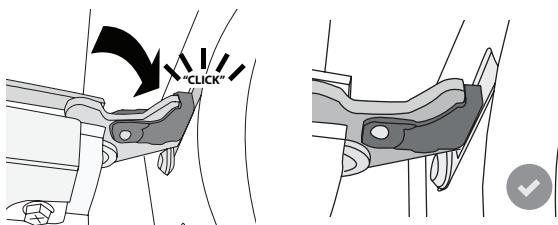
**5.** Încercați să închideți ușa și asigurați-vă că se aliniază cu panoul de comandă. În caz contrar, repetați pașii de mai sus: Ușa s-ar putea deteriora dacă nu funcționează corespunzător.
