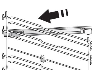
Demontați ghidaje pentru grătar din cuptor și îndepărtați folia protectoare din plastic de pe șinele culisante.
