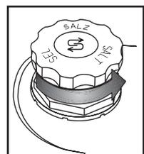
Indicador visual (conforme o modelo). Desaperte a tampa.
