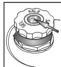
Aperte a tampa. Os resíduos de sal à volta da tampa devem ser removidos. Alguns depósitos de sal têm um indicador de nível integrado na tampa (veja abaixo como verificar).
