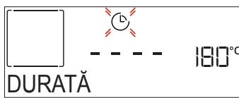
Când pictograma clipește pe afișaj, apăsați pe + sau — pentru a seta durata de preparare dorită, iar apoi apăsați pe ✓ pentru a confirma. Nu este necesar să setați durata de preparare dacă doriti să gestionați manual procesul de preparare (necronometrat): Apăsați pe ✓ sau , pentru a confirma și a activa funcția. Prin selectarea acestui mod, nu puteți programa o pornire temporizată.
