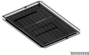
Poate fi utilizată atunci când gătiți alimente cu funcția Prăjire cu aer, cu o tavă de copt poziționată la un nivel inferior pentru a colecta eventualele firmituri și picături. Aceasta poate fi spălată în mașina de spălat vase.
