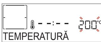
Când valoarea clipește pe afișaj, apăsați pe + sau — pentru a o modifica, apoi apăsați pe ✓ pentru a confirma și continuați cu setările care urmează (dacă este posibil).
