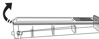
1. Empuje hacia arriba la solapa posterior para retirar la tapa superior del cajón de agua.
