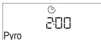
Apăsați pe sau pentru a selecta ciclul dorit, apoi apăsați pe pentru a confirma. Odată ce a fost selectat un ciclu, dacă doriți, apăsați pe sau pe pentru a seta ora de finalizare (pornire cu întârziere), iar apoi apăsați pe pentru a confirma.
