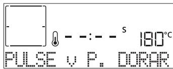
Cuando la pantalla lo indique, si lo desea pulse para iniciar un ciclo de gratinado de cinco minutos. Puede detener la función en cualquier momento pulsando para apagar el horno.
