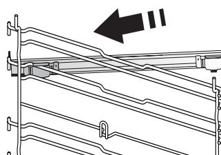
Extraiga las guías para los estantes del horno y quite el plástico de protección de las guías deslizantes.
