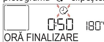
Apăsați pe + sau — pentru a seta ora la care doriti să se finalizeze procesul de preparare, apoi apăsați pe ✓ pentru a confirma și a activa funcția. Introduceți alimentele în cuptor și închideți ușa: Funcția va porni automat după calcularea perioadei de timp necesară pentru finalizarea preparării la ora setată.
