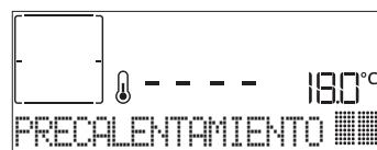
Cuando el precalentamiento haya terminado, sonará una señal acústica y la pantalla indicará que el horno ha alcanzado la temperatura establecida y le pedirá «AÑADIR ALIMENTO». En ese momento, abra la puerta, coloque los alimentos en el horno y cierre para iniciar la cocción pulsando **✓** o **▷**.
