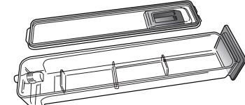
2. Una vez realizada la limpieza, puede cerrar el cajón introduciendo las dos solapas delanteras dentro de las aberturas delanteras y empujando hacia abajo la parte trasera.
