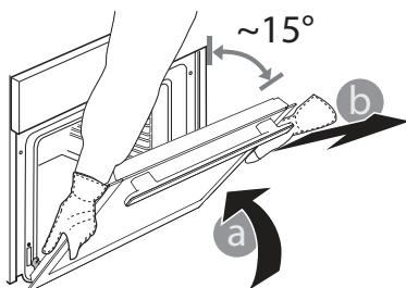
**3.** Remontați ușa deplasând-o spre cuptor, aliniind cuplajele bălamalelor cu locașurile și fixând partea superioară în locaș.
