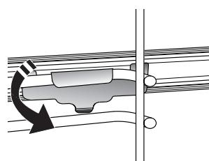
Cuplați clema superioară a ghidajului pe ghidajul pentru grătar și culisați-l până la capăt. Coborâți și cealaltă clemă în poziție.
