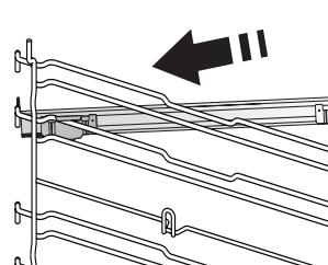
Demontați ghidajele pentru grătar din cuptor și îndepărtați folia protectoare din plastic de pe șinele culisante.
