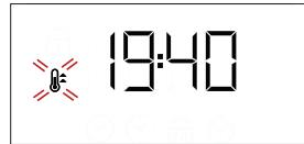
Per interrompere una funzione in qualsiasi momento, spegnere il forno, ruotare la *manopola di selezione* e la *manopola del termostato* su O e ●.
