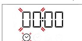
Utilisez + ou — pour régler l'heure et appuyez sur ⏱ pour confirmer. Les deux chiffres des minutes clignotent. Utilisez + ou — pour régler les minutes et appuyez sur ⏱ pour confirmer.
