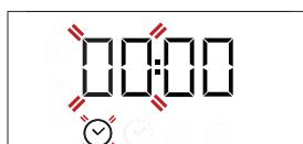
Utilice **+** o **-** para ajustar la hora y pulse para confirmar. Los dos dígitos de los minutos empezarán a parpadear. Utilice **+** o **-** para ajustar los minutos y pulse para confirmar.
