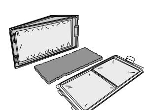
Pričvrstite pjenasti dio filtra na donji filter. Komoru filtra na sušilici očistite vlažnom krpom ili pažljivo upotrebljavajući usisavač. Ponovno umetnite donji filter. Gurnite ručku filtra prema dolje i zatvorite donja preklopna vratača.
