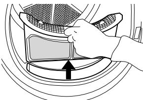
Pritisnite gumb kako biste otvorili filter vrata. Izvadite otpatke koji se u njemu nalaze. Zatvorite filter i ponovno ga umetnite u ispravnom smjeru tako da se do kraja uklopi u komoru filtra.
