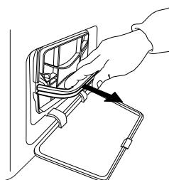
Otvorite preklopna vratača na dnu. Uhvatite ručku i izvucite donji filter.
