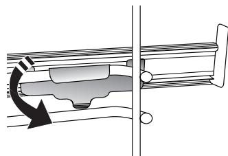
Varmista ohjain paikalleen painamalla pidikkeen alaosaa tiukasti hyllykkööhjainta vasten. Varmista, että liukukiskot voivat liikkua vapaasti. Toista nämä vaiheet toiselle hyllykkööhjaimelle samalla tasolla.
