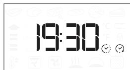
Vennligst merk: Ved å programmere en utsatt start for steeking vil en alltid utelukke fasen for forvarming av ovnen. Ovnen vil gradvis nå temperaturen du ønsker, dette betyr at steketiden blir noe lengre enn det som vises i tilberedningstabellen.
