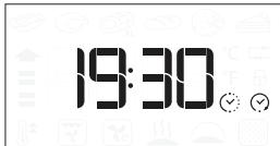
Anmärkning: När en fördöjd start programmas avaktiveras ugnens förvärmningsfas. Ugnen kommer att uppnå önskad temperatur gradvis, vilket betyder att tillagningstiderna är något längre än de som listas i tillagningstabellen.
