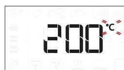
Drej på knappen, når ikonet °C/F blinker på displayet, for at ændre værdien og tryk herefter på , for at bekræfte og (om muligt) fortsætte med at ændre de efterfølgende indstillinger.
