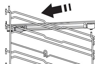
Fäst den rörliga skenans övre klämma på ugnsstegen och låt den glida in så långt som den går. Sänk ner den andra klämmman på plats.
