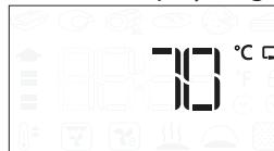
Wenn der Kerntemperaturfühler während der Auswahl einer Funktion eingesteckt wird, wechselt das Display zur Standard-Zieltemperatur des Kerntemperaturführers.
