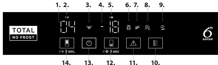
1. Chiffres de température de réfrigérateur
