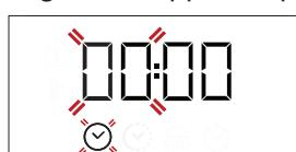
Gebruik + of - om de uren in te stellen en druk op ☺ om te bevestigen. Op het display gaan de twee cijfers die de minuten aangeven knipperen. Gebruik + of - om de minuten in te stellen en druk op ☺
