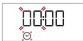
Mit + oder — die Stunde einstellen und ⌂ zur Bestätigung drücken. Die beiden Ziffern für die Minuten beginnen zu blinken. Mit + oder — die Minuten einstellen und ⌂ zur Bestätigung drücken.
