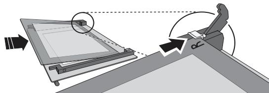
Die obere Ecke wieder anbringen: Ein Klick bestätigt die richtige Positionierung. Sicherstellen, dass die Dichtung vor Wiedereinbau der Tür befestigt wird.
