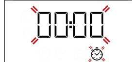
Gebruik + of - om de tijd te regelen en druk op om te bevestigen.
