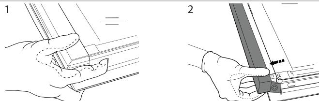
Das Innenglas mit beiden Händen anheben und fest halten, es entfernen und auf eine weiche Fläche legen, um es daraufhin zu reinigen.
