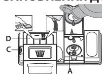
Ополіскувач полегшує СУШІННЯ посуду. Дозатор ополіскувача **A** слід заповнювати, коли на панелі керування світиться **індикаторна лампа «ЗАПОВНЕННЯ ОПОЛІСКУВАЧЕМ»**.
