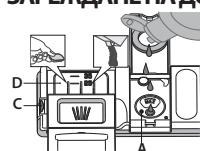
Помошното средство за изплакване улеснява сушенето. Дозаторът за помощното средство за изплакване **A** трябва да се пълни, когато светлинният индикатор **ЗАРЕЖДАНЕ НА ПОМОЩНО СРЕДСТВО ЗА ИЗПЛАКВАНЕ** на контролния панел светне.
