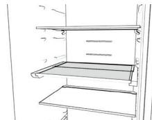
2. Halv dybde, for at bruge den bagerste del og dermed skabe plads til høje genstande (såsom flasker og kander) på den underliggende hylde. Hylden foldes sammen til den halve dybde ved at løfte det forreste afsnit en smule og herefter skubbe det indad.
