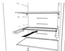
3. Vippet op, hvis du har brug for at skabe plads til høje eller store genstande på den underliggende hylde. Før hylden vippes op, skal den justeres til positionen halvejs fra den halve dybde. Vip hylden ned igen, for at vende tilbage til at bruge den i halv eller fuld dybde.
