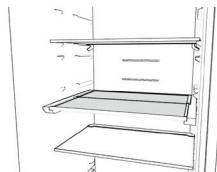
2. Halv dybde, for å bruke den bakre delen samtidig som en skaper plass for høyere gjenstander (som flasker og mugger) på hyllan nedenfor. For å justere hyllan til halv dybde, hev den fremre delen noe og skyv den inn.
