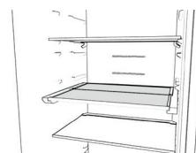
2. Puolen syvyyden verran, takaosan käyttämiseksi siten, että alahyllyllä oleville korkeammille esineille (kuten esimerkiksi pulloille ja kannuille) jää tilaa. Hyllyn syvyys säädetään puoleen nostamalla hieman etuosaa ja vetämällä se sitten sisään.
