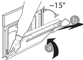
**Įstatydami dureles pastumkite jas link orkaitės, sulygiuokite vyrių kabliukus tvirtinimo vietose ir užfiksuodami viršutinę dalį.**
