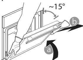
Per rimontare la porta, avvicinarla al forno allineando i ganci delle cerniere alle proprie sedi e ancorare la parte superiore agli alloggiamenti.
