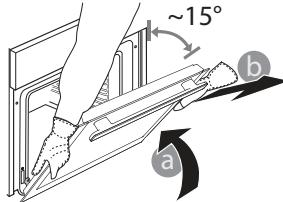
**Ukse tagasisipaigaldamiseks** asetage see vastu ahju, joondage hingedede haagid pesadega ja kinnitage ülemine osa oma pessa.
