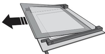
**3.** Riapplicare il vetro intermedio (contrassegnato con "R") prima di rimontare il vetro interno: Per posizionare correttamente i vetri, verificare che la marcatura "R" sia visibile nell'angolo sinistro. Inserire dapprima il lato lungo del vetro contrassegnato con "R" nelle sedi di sostegno, quindi abbassarlo in posizione. Ripetere la procedura per entrambi i vetri.
