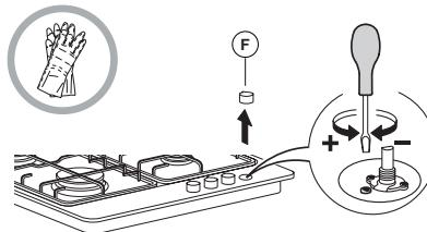
Po zakończeniu regulacji, należy dokonać ponownego uszczelnienia używając kitu próżniowego lub równoważnego materiału.
