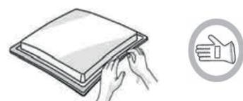
Positionieren Sie das Kochfeld in der Öffnung in der Arbeitsfläche, die gemäß den in der Anleitung angegebenen Abmessungen angefertigt wurde.
