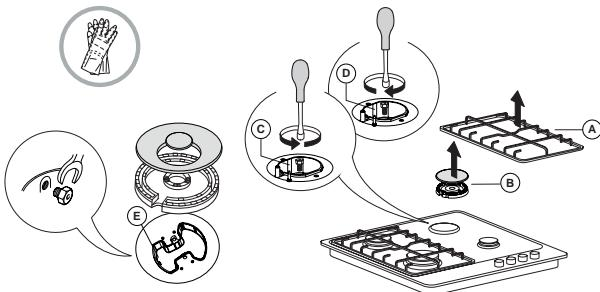
Před instalací varné desky nezapomeňte připevnit kalibrační štítek dodaný s injektoři takovým způsobem, aby zakryl původní informace týkající se kalibrace pro plyn.
