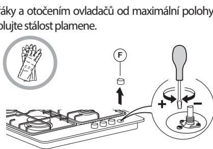
Po dokončení nastavení provedte utěsnění pomocí pečetního vosku nebo obdobného materiálu.
