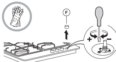
Nach Abschluss der Einstellung dichten Sie mit Siegelwachs oder ähnlichem Material ab.
