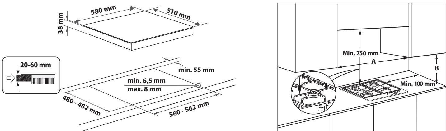
**POZNÁMKA:** Pokud vzdálenost „A“ mezi stěnami linky činí 600mm až 730 mm, musí výška „B“ činit minimálně 530 mm.
