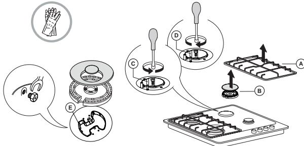
Înainte de a instala plita, nu uitați să montați plăcuța cu datele privind calibrarea gazului, livrată împreună cu injectoarele, astfel încât să acopere informațiile existente referitoare la calibrarea gazului.
