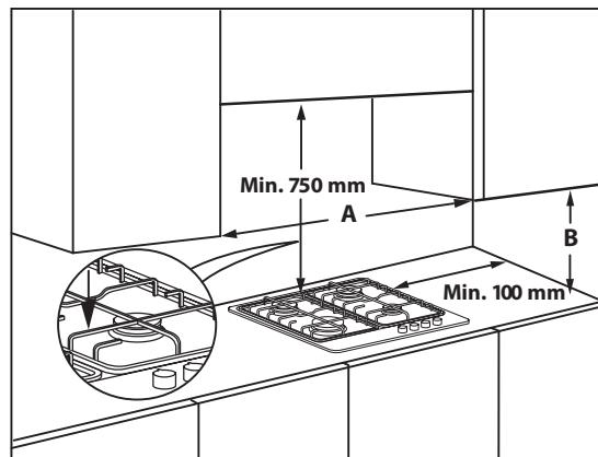
**POZNÁMKA:** ak je vzdialenosť „A“ medzi nástennými skrinkami 600 mm až 730 mm, výška „B“ musí byť minimálne 530 mm.
