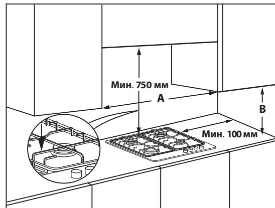
**ПРИМІТКА.** Якщо відстань «A» між настінними шафами має значення в діапазоні від 600 до 730 мм, висота «Б» повинна мати значення принаймні 530 мм.
