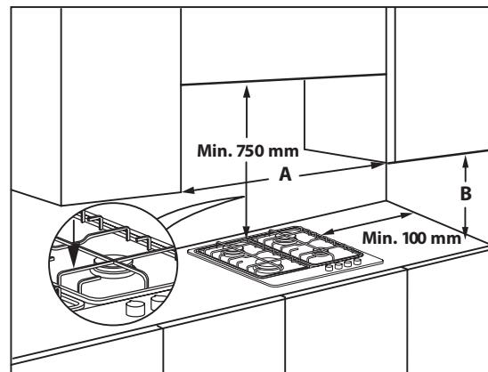
**NOTĂ:** dacă distanța "A" dintre dulapurile suspendate este între 600 mm și 750 mm, înălțimea "B" trebuie să fie de cel puțin 530 mm.
