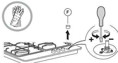
Na het voltooien van de afstelling, dient u afdichtwas of een vergelijkbaar materiaal te gebruiken om af te dichten.
