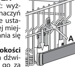
Górny kosz jest wyposażony w **regulator wysokości górnego kosza** (patrz ilustracja); bez naciskania dźwigienek, można łatwo podnieść kosz trzymając go za boczne części i umieszczając stabilnie w górnym położeniu. Aby przywrócić dolne położenie, nacisnąć dźwigienki A po bokach kosza i przesunąć kosz w dół.
