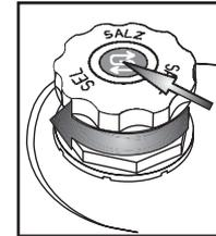
Vissez le bouchon. Éliminez les résidus de sel autour du bouchon. Certains réservoirs à sel possèdent un indicateur de niveau intégré dans le bouchon (reportez-vous à la méthode de contrôle ci-dessous).
