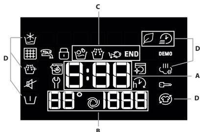
Die Dauer der verfügbaren Waschgänge und die Restzeit des aktuellen Waschgangs werden im Bereich **A** angezeigt (das Display zeigt zunächst die maximale Dauer des gewählten Waschgangs an, die nach ein paar Minuten abnehmen kann, da die tatsächliche Dauer eines Waschprogramms von der Wäscheladung und den gewählten Einstellungen abhängt). Wenn die Option VERZÖGERTER START gewählt wurde, wird der Countdown bis zum Start des ausgewählten Waschgangs angezeigt.
