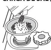
1. Retire la bandeja inferior y desenrosque el tapón del depósito (en sentido antihorario).
