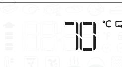
Pokud dojde k připojení teploměru v průběhu výběru funkce, prepne se displej na výchozí cílovou teplotu pro teplomér do masa.
