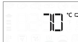
Če je sonda za meso nameščena, medtem ko izbirate funkcijo, se na prikazovalniku pojavi prevzeta ciljna temperatura sonde mesa.
