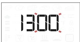
Števki za minute začneta utripati. Z obračanjem gumba nastavite minute in pritisnite za potrditev.
