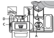
L'utilizzo di brillantante facilita il processo di ASCIUGATURA delle stoviglie. Il distributore di brillantante **A** deve essere riempito ogni volta che a spia dell'**indicatore di RIEMPIMENTO BRILLANTANTE** sul pannello comandi è illuminata.
