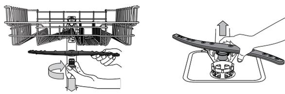
Per smontare il braccio aspersore superiore, ruotare l'anello di bloccaggio in plastica in senso orario.
