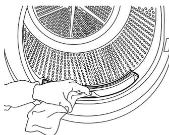
**5.** Fermez le filtre et réinsérez-le dans la bonne direction, de sorte qu'il intègre totalement le compartiment de filtre.
