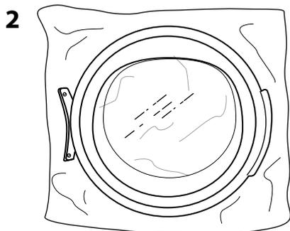
**7.** Tournez avec précaution le châssis de porte dans le sens des aiguilles d'une montre et enlevez-le.
