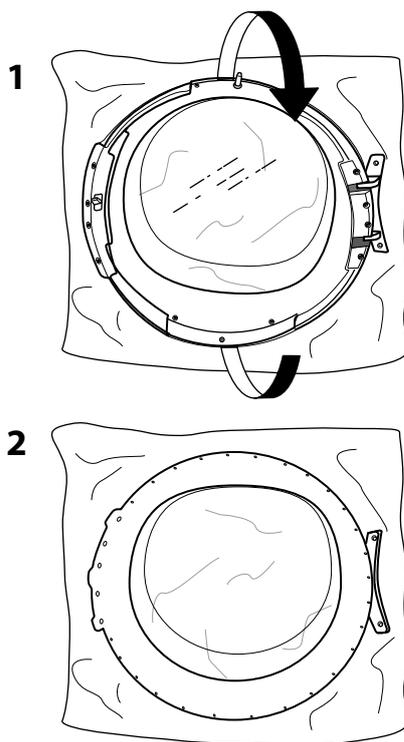
**16.** Réinstallez le châssis de porte.
