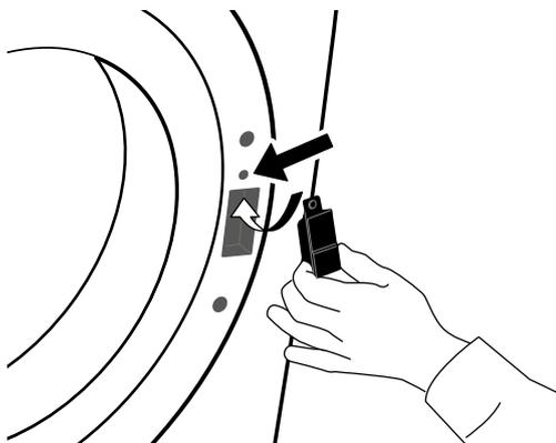
**19.** Fixez les deux vis au-dessus et sous le verrou de porte, sur le côté droit de l'ouverture de porte.
