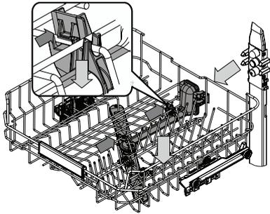
À l'occasion, des résidus de nourriture s'incrûstent dans les bras d'aspersion et bloquent les trous utilisés pour asperger de l'eau. Il est donc conseillé de vérifier les bras de temps en temps et de les nettoyer avec une petite brosse non métallique. Pour démonter le bras d'aspersion intermédiaire, il faut déclipser l'ensemble collecteur d'eau situé sous le panier supérieur.
