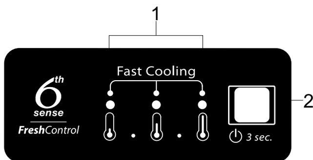
1. LEDs indicadores (apresentam a atual temperatura programada ou a função de Arrefecimento Rápido)
