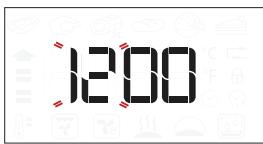
Op het display gaan de twee cijfers die het uur aangeven knipperen: Draai aan de knop om het uur in te stellen en druk op om te bevestigen.
