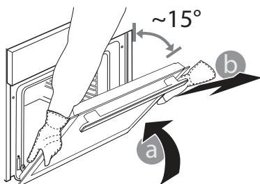
3. Monteer de deur opnieuw door deze te bewegen in de richting van de oven, de haken van de scharnieren uit te lijnen met de zitting en het bovenste deel op de zitting vast te zetten.
