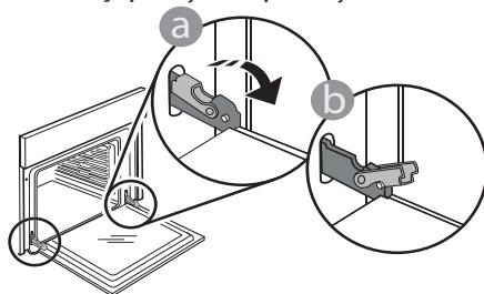
trägând-o în sus în același timp, până când se eliberează din locaș. Lăsați ușa deoparte, sprijinită pe o suprafață moale.
