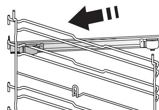
Cuplați clema superioară a ghidajului pe ghidajul pentru grătar și culisați-l până la capăt. Coborâți și cealaltă clemă în poziție.
