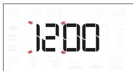
Die beiden Ziffern für die Stunden beginnen zu blinken: Den Knopf drehen, um die Stunden einzustellen und ⌂ zur Bestätigung drücken.
