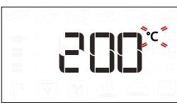
Ked' na displeji bliká ikonka °C/°F, otáčaním gombíka zmeňte hodnotu, potvrdte stlačením a pokračujte zmenou ďalších nastavení (ak je to možné).
