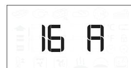
Den Auswahlknopf zur Auswahl des Nennstroms drehen, anschließend ⌂ zur Bestätigung drücken.
