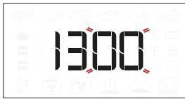
Op het display gaan de twee cijfers die de minuten aangeven knipperen. Draai aan de knop om de minuten in te stellen en druk op om te bevestigen.
