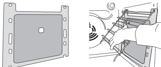
Om optimaal gebruik te maken van de zelfreinigende eigenschappen van de katalytische voeringen raden we aan de oven te verwarmen tot 200 °C gedurende ongeveer een uur, met de functie "Convectiekassen". De oven moet leeg zijn gedurende deze tijd. Laat het apparaat daarna afkoelen en gebruik een niet-schurende spons om eventuele etensresten te verwijderen.
