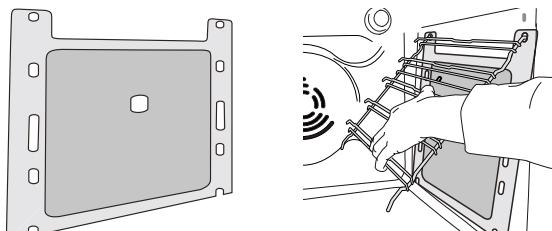
Pour profiter au maximum des propriétés auto-nettoyantes des panneaux catalytiques, nous vous conseillons de chauffer le four à 200 °C pour environ une heure en utilisant la fonction « Convection forcée ». Le four doit être vide durant cette opération. Laissez ensuite le four refroidir avant d'enlever les résidus d'aliments qui restent avec une éponge non abrasive.
