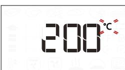
Jeżeli na ekranie migają ikonki  $^{\circ}\text{C}/^{\circ}\text{F}$ , zmienić wartość za pomocą pokrętła, a następnie wcisnąć , aby zatwierdzić wybór i kontynuować zmianę ustawień kolejnych parametrów (o ile to możliwe).
