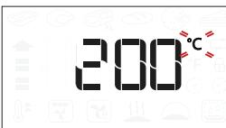
Wanneer het  $^{\circ}\text{C}/^{\circ}\text{F}$  pictogram knippert op het display draai dan aan de knop om de waarde te veranderen, druk daarna op om te bevestigen en ga verder met het wijzigen van de instellingen die volgen (indien mogelijk).
