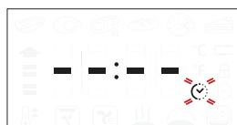
Wanneer het pictogram knippert op de display, gebruik de instelknop om de gewenste bereidingstijd in te stellen en druk dan op om te bevestigen.
