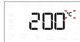
Wenn die Symbole °C/F auf dem Display blinken, den Knopf drehen, um den Wert zu ändern, anschließend ⌂ zur Bestätigung drücken und fortfahren, um die nachfolgenden Einstellungen zu ändern (falls möglich).
