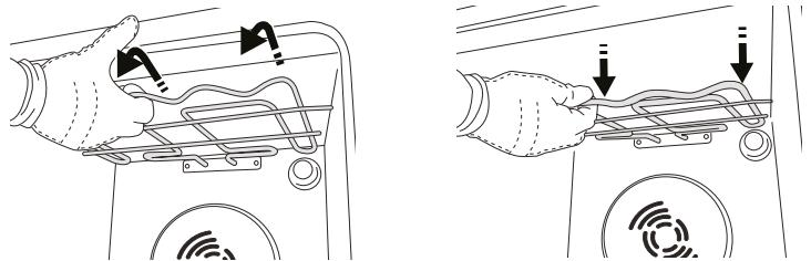
**3.** Zpět ho vrátíte tak, že ho zvednete nahoru a přitom mírně přitáhněte směrem k sobě. Zkontrolujte, zda leží na bočních držácích.
