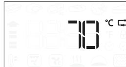
Jeżeli sonda do mięsa zostanie podłączona podczas wyboru funkcji, wyświetlacz przełączy się na domyślną docelową temperaturę sondy do mięsa.
