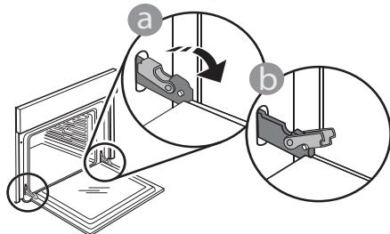
cały czas i jednocześnie wyciągając do góry, aż wysuną się z miejsc zamocowania. Odłożyć drzwiczki na bok, umieszczając je na miękkim podłożu.
