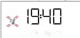
Veuillez noter : Lors de la cuisson, vous pouvez changer la fonction en tournant le bouton de sélection ou ajuster la température en tournant le bouton du thermostat. La fonction ne démarre pas tant que le bouton de thermostat est sur la position **0** /AUTO. Vous pouvez régler le temps de cuisson, le temps de fin de cuisson (seulement si vous réglez le temps de cuisson) et la minuterie.
