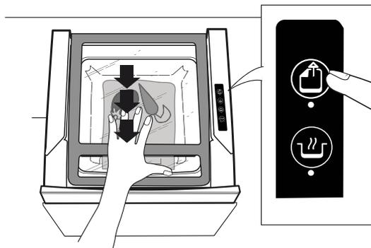
Un joint parfait est essentiel pour le maintien des conditions sous vide dans le sac. Ceci peut être confirmé par un joint clairement visible et l'absence de traces de brûlure. Assurez-vous que le joint se trouve à la hauteur des pointillés du sac KitchenAid, ou qu'il est parallèle à cette ligne.
