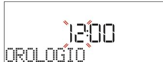
Ruotare la **manopola di regolazione** per impostare l'ora desiderata e premere : sul display lampeggiano le due cifre relative ai minuti. Ruotare la **manopola di regolazione** per impostare i minuti e premere  per confermare.
