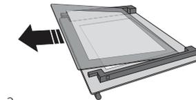
3 Para volver a colocar los cristales interiores correctamente, asegúrese de que «R» se pueda leer en la esquina izquierda y la superficie lisa (no impresa) esté cara arriba. Primero introduzca el lado largo del cristal marcado con una «R» en los soportes y después bájelos hasta su posición (4). Vuelva a colocar la parte superior (5): un clic le indicará que se ha colocado correctamente. Asegúrese de que el precinto esté asegurado antes de volver a montar la puerta.
