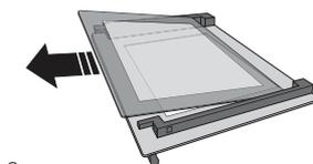
Para voltar a instalar o vidro interior, certifique-se de que a letra "R" está visível no canto esquerdo e que a superfície límpida (não impressa) está voltada para cima. Insira primeiro a parte mais longa do vidro com a indicação "R" nos alojamentos dos suportes e, em seguida, baixe-a até à posição correta (4). Instale novamente a extremidade superior (5): irá ouvir um clique, indicando que está bem posicionado. Certifique-se de que a vedação está segura antes de montar novamente a porta.
