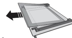
Pour bien replacer la vitre intérieure, assurez-vous que le « R » est visible dans le coin gauche et que la surface claire (pas d'imprimée) est placée vers le haut. En premier, insérez la longue partie de la vitre marquée d'un « R » dans les appuis des guides, abaissez-la ensuite en place (4). Remplacez le bord supérieur (5) : un déclic indique le positionnement correct. Assurez-vous que le joint est bien placé avant de replacer la porte.
