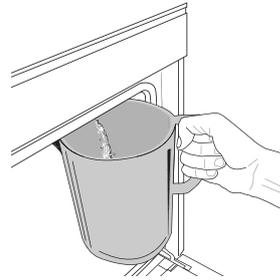
Uma vez selecionada a função "Drain" (Drenagem), siga as ações indicadas: Abra a porta e coloque um recipiente grande por baixo do bico de drenagem localizado na parte inferior direita do painel. Uma vez iniciada a drenagem, mantenha o recipiente em posição até que a drenagem esteja concluída. A duração média da drenagem de
