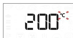
Jeżeli na ekranie migają ikonka °C/°F, zmienić wartość za pomocą pokrętła, a następnie wcisnąć , aby zatwierdzić wybór i kontynuować zmianę ustawień kolejnych parametrów (o ile to możliwe).
