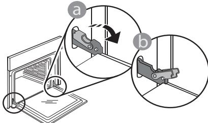
ih zatvarate dok ih istovremeno povlačite nagore i oslobađate iz njihovog ležišta. Položite vrata da leže na jednoj strani, na mekanoj površini.
