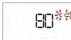
Obrócić pokrętło, aby ustawić temperaturę komory piekarnika. Nacisnąć lub , aby potwierdzić i zacząć cykl pieczenia. Podczas cyku pieczenia, na wyświetlaczu jest pokazywana docelowa temperatura sondy do mięsa. Gdy mięso osiągnie docelową temperaturę, cykl pieczenia zakończy się, a na wyświetlaczu pojawi się napis „Koniec”.
