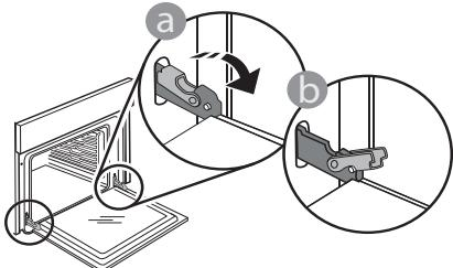
Išimkite dureles atlikdami ju uždarymo veiksmą ir šiek tiek patraukdami į viršų, kad išlaisvintumėte iš tvirtinimo vietos. Išimtas dureles paguldykite ant minkšto paviršiaus.
