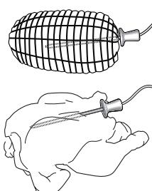
Posiționarea corectă a sondei este extrem de importantă pentru obținerea unor rezultate de preparare perfecte. Introduceți complet sonda în carne, evitând zonele osoase și părțile cu grăsimi.
