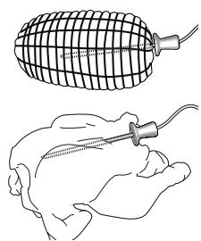
Izvadite sondu iz rerne. Povežite kraj sonde sa otvorom koji se nalazi na desnom zidu unutrašnjosti rerne. Kada je sonda za meso prikačena za unutrašnjost rerne, čuje se zvučni signal i pojavljuje se ikona na displeju kao i ciljana temperatura.
