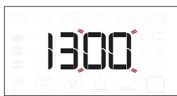
Števki za minute začneta utripati. Z obračanjem gumba nastavite minute in pritisnite ☰ za potrditev.
