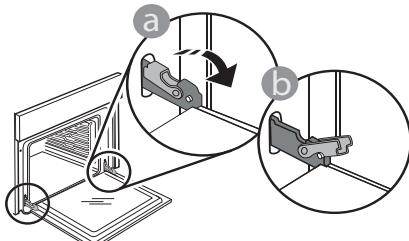
zatvarati dok ih istovremeno vučete prema gore dok se ne otpuste iz ležišta. Stavite vrata sa strane, oslanjajući ih na meku površinu.
