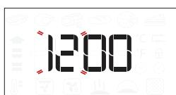
Dispļejā mirgos divi cipari, kas apzīmēs stundas: Pagrieziet slēdzi, lai iestatītu stundas, un nospiediet , lai apstiprinātu.
