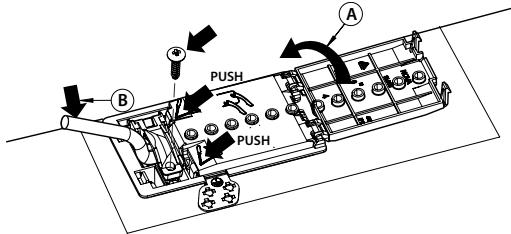
**Spotrebič musí byť pripojený k zdroju napájania prostredníctvom viacpolového spínača s minimálnou vzdialenosťou medzi kontaktmi 3 mm.**
