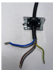
Fixez le cordon d'alimentation au support en plastique.
