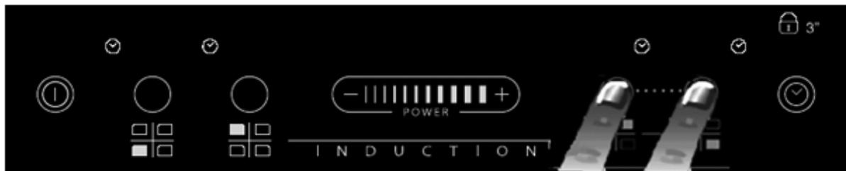
Para alterar o nível de potência (de 1 até ao máximo de 9 ou P), prima as teclas +/- ou deslize o dedo horizontalmente no controlo deslizante. Para desactivar a função "Flexi cook", prima simultaneamente as 2 teclas de selecção das superfícies. Para desligar as superfícies de cozedura instantaneamente, prima uma das teclas de selecção da superfície por 3 segundos.
