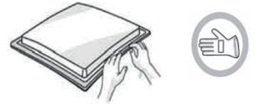
Posicione a placa sobre a abertura da bancada que foi feita respeitando as dimensões indicadas nas Instruções.
