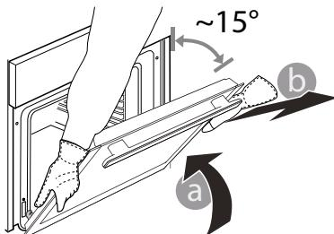
**3.** Įstatydami dureles pastumkite jas link orkaitės, sulygiuokite vyrių kabliukus tvirtinimo vietose ir užfiksuoami viršutinę dalį.
