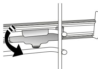
Aby byla vodicí mřížka dobře zajištěna, zatlačte pevně spodní část spony oproti vodicí mřížce. Ujistěte se, že drážkami lze volně pohybovat. Postupujte stejně i na druhé straně vodicí mřížky v rámci stejné výškové úrovni.
