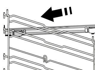
Vyberte vodiace lišty z rúry a z posuvných bežcov odstráňte ochranné plasty. Pripevnite vrchnú svorku bežca na vodiacu lištu a nasuňte, pokiaľ to ide. Druhú svorku spustite na miesto.
