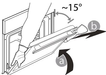
**3.** Dvířka opět nasadíte tak, že je přiložíte k troubě, namířujete háčky pantů oproti jejich usazení a do příslušného usazení zajistíte i horní část.
