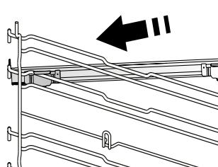
Išimkite lentynų laikiklius iš orkaitės ir nuimkite apsaugines plastikines dalis nuo slankiojančių grotelių. Viršutinių grotelių fiksatorių pritvirtinkite prie skersinių grotelių ir nustumkite jų iki galio. I tą padėtį nuleiskite ir kitą fiksatorių.
