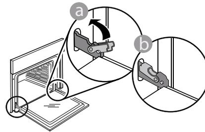
Presione suavemente para comprobar que los pestillos estén en la posición correcta.
