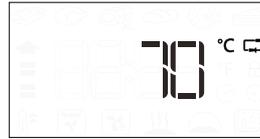
Πιέστε για έναρξη των ρυθμίσεων. Στρέψτε τον επιλογέα για να ρυθμίσετε τον αισθητήρα κρέατος στη στοχευόμενη θερμοκρασία. Πιέστε για επιβεβαίωση. Στρέψτε το κουμπί για να επιλέξετε τη θερμοκρασία φούρνου.
