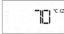
Pulse para iniciar los ajustes. Gire el selector para programar la temperatura prevista para la sonda para carne. Pulse para confirmar.
