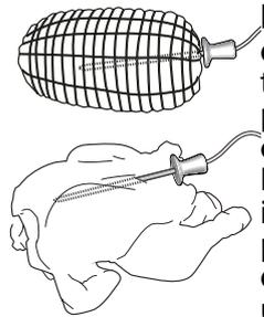
Quand la sonde à viande est insérée dans la cavité du four, un signal sonore est activé et l'écran présente l'icône et la température à atteindre.
