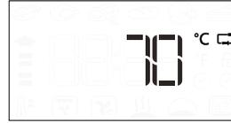
Appuyez sur pour démarrer les réglages. Tournez le bouton pour régler la température cible de la sonde à viande. Appuyez sur pour confirmer. Tournez le bouton pour régler la température de la cavité du four.
