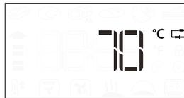
Premere per iniziare l'impostazione dei valori. Ruotare la manopola per impostare la temperatura desiderata per la sonda. Premere per confermare. Ruotare la manopola per impostare la temperatura interna del forno.
