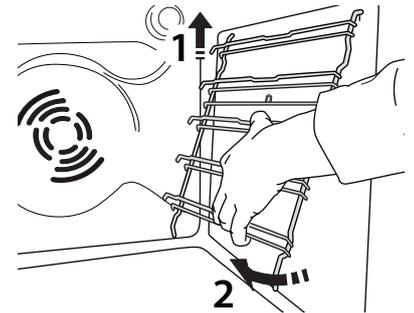
Pour remplacer les supports de grille, vous devez en premier les replacer dans leur appui supérieur. En les maintenant soulevés, glissez-les dans le compartiment de cuisson, abaissez-les ensuite dans leur appui inférieur.
