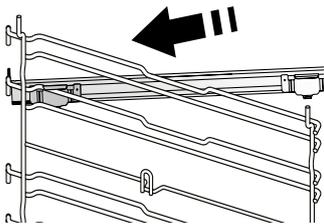
Fixe o encaixe superior da corredeira à guia de nível e faça-a deslizar até parar. Baixe o outro encaixe para o posicionar.
