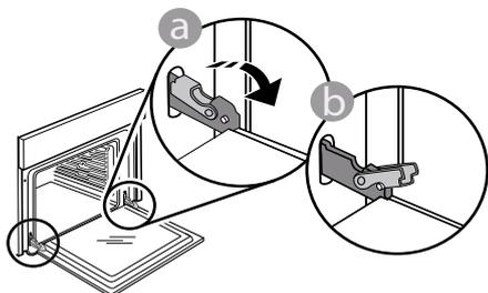
Remova, simplesmente, a porta, continuando a fechá-la enquanto a puxa, simultaneamente, para cima, até se libertar do respetivo suporte. Coloque a porta de parte, apoiando-a sobre uma superfície suave.
