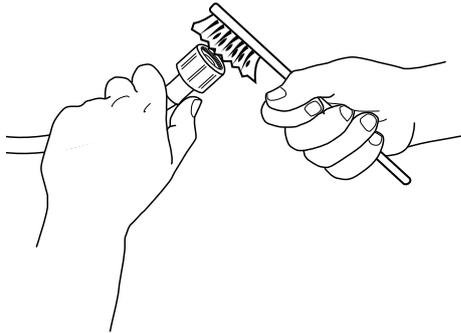
**3.** Dévissez ensuite à la main le tuyau d'alimentation au dos du lave-linge. Sortez le filtre à tamis de la soupape au dos du lave-linge avec des pinces et nettoyez-le soigneusement.
