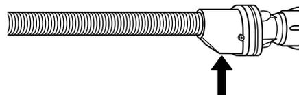
Pour les tuyaux d'arrêt d'eau : vérifiez la fenêtre d'inspection de la petite soupape de sécurité (voir la flèche). Si elle est rouge, la fonction d'arrêt d'eau a été déclenchée et le tuyau doit être remplacé. Pour dévisser ce tuyau, appuyez sur le bouton de déverrouillage (si disponible) tout en dévissant le tuyau.
