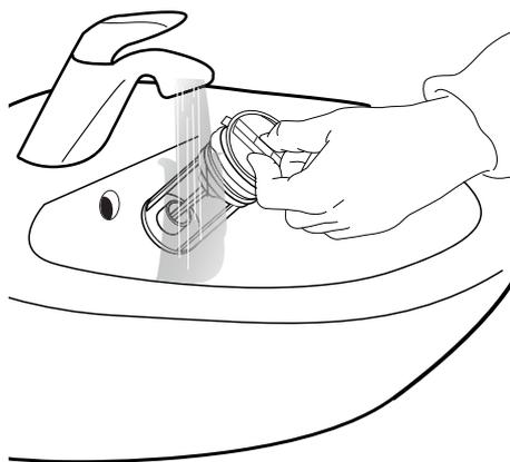
**6.** Insérez le filtre d'eau et réinstallez la plinthe : Replacez le filtre d'eau en le tournant dans le sens horaire. Assurez-vous de le tourner aussi loin que possible ; la poignée du filtre doit être en position verticale. Pour vérifier l'étanchéité du filtre d'eau, vous pouvez verser environ 1 litre d'eau dans le distributeur de détergent. Replacez ensuite la plinthe.
