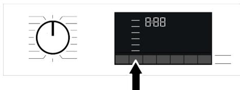
Chaque fois qu'un nouveau programme est sélectionné, la vitesse d'essorage recommandée du programme sélectionné s'affiche sur le voyant de vitesse d'essorage. Il est possible que la vitesse d'essorage recommandée ne soit pas la valeur maximale pouvant être sélectionnée pour le programme en cours.
