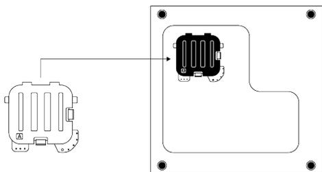
Inclinez légèrement la machine vers l'arrière. Posez les languettes du couvercle A contre le panneau inférieur. Terminez l'assemblage en tournant le couvercle.
