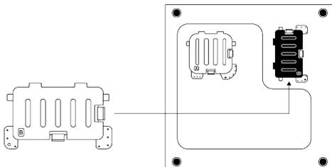
Posez les languettes du couvercle B contre le panneau inférieur. Terminez l'assemblage en tournant le couvercle.
