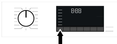
Chaque fois qu'un nouveau programme est sélectionné, la température recommandée pour ledit programme apparaît sur l'indicateur de température. Il est possible que la température recommandée ne soit pas la température maximale pouvant être sélectionnée pour le programme en cours.
