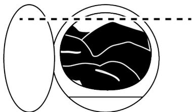
Dans le programme lavage 8 kg et séchage 8 kg, il est recommandé de charger la machine jusqu'au niveau indiqué dans la figure ci-dessus pour des conditions de séchage idéales (vous pouvez voir la flèche de niveau si vous ouvrez la porte de chargement).
