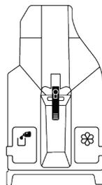
2. Pour mettre du détergent liquide (gauche) et de l'adoucissant (droite), ouvrez le couvercle de chaque réservoir en le relevant comme indiqué dans le schéma.
