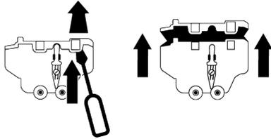
7. Retirez les languettes qui maintiennent le couvercle du tiroir à détergent à l'aide d'un tournevis à tête plate (il y a 6 languettes au total, deux à droite, deux à gauche et deux à l'arrière du tiroir) et lavez l'intérieur du tiroir.
