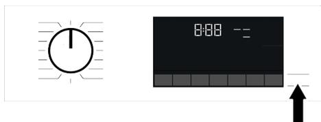
Si le niveau d'eau dans la machine est inapproprié lorsque vous appuyez sur le bouton Marche/Pause, le verrouillage de porte ne peut pas être désactivé et son icône reste active à l'écran.
