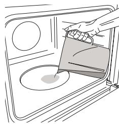
Wenn der Ofen kalt ist, die Aussparung mit der in der entsprechenden Gartabelle empfohlenen Menge an Trinkwasser füllen. Die Funktion steam · einstellen und aktivieren: Am Ende vorsichtig die Tür öffnen und Dampf langsam austreten lassen.
