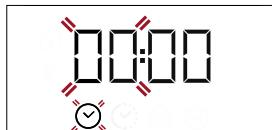
Gebruik ☰ of ☱ om de uren in te stellen en druk op ☰ om te bevestigen. Op het display gaan de twee cijfers die de minuten aangeven knipperen. Gebruik ☰ of ☱ om de minuten in te stellen en druk op ☰ om te bevestigen.
