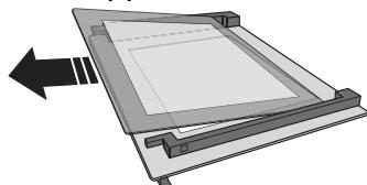
3. Herplaats het middenpaneel (gemarkerd met "R") voordat u het binnenpaneel terugplaatst: Om de ruiten correct terug te plaatsen, zorg ervoor dat het merk "R" zichtbaar is in de linkerhoek. Breng eerst de lange zijde van de ruit met het merk "R" in de zittingen, en breng de ruit omlaag tot die op zijn plek komt. Herhaal deze procedure voor beide glasruit.
