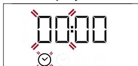
Mit oder die Stunde einstellen und zur Bestätigung drücken. Die beiden Ziffern für die Minuten beginnen zu blinken. Mit oder die Minuten einstellen und zur Bestätigung drücken.
