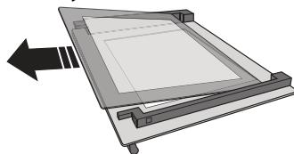
3. Réinstaller le panneau intermédiaire (marqué d'un "R") avant de replacer le panneau intérieur : Pour placer correctement les parois de verre, assurez-vous que la marque « R » se trouve dans le coin gauche. En premier, insérez la longue partie de la vitre marquée d'un « R » dans les appuis des guides, abaissez-la ensuite en place. Répétez cette procédure pour les deux parois de verre.
