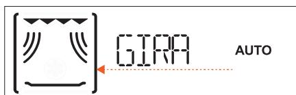
Quando il forno interrompe la cottura, aprire la porta per eseguire le operazioni indicate, quindi chiuderla e premere ➤ per riprendere al cottura.
