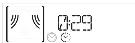
Per tornare a visualizzare il timer, attendere il termine della funzione o spegnere il forno premendo ⓧ.
