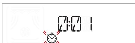
Premere OK per avviare il timer: un segnale acustico e il display avviseranno del termine del conto alla rovescia.
