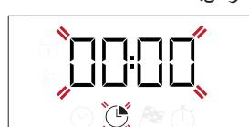
استخدم **+** أو **-** لضبط مدة الطهي المرغوبة، ثم اضغط على للتأكيد. قم بتنعيم الوظيفة عن طريق إدارة مفتاح الترمومسات إلى درجة الحرارة المرغوبة، وستصدر إشارة صوتية وتنبئ وحدة العرض إلى اكتمال الطهي.
