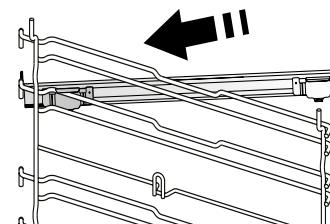
Замкніть верхній затискач телескопічної напрямної на напрямній для решітки та просуньте його вздовж напрямної до упору. Опустіть на місце інший затискач.
