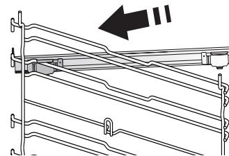
Cuplați clema superioară a ghidajului pe ghidajul pentru grătar și culisați-l până la capăt. Coborâți și cealaltă clemă în poziție.
