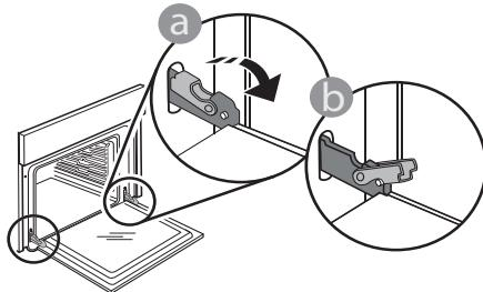
zatvarati dok ih istovremeno vučete prema gore dok se ne otpuste iz ležišta. Stavite vrata sa strane, oslanjajući ih na meku površinu.
