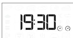
Nota: programmare l'avvio ritardato di una cottura, disattiva in ogni caso la fase di preriscaldamento del forno: la temperatura desiderata viene raggiunta gradualmente, quindi i tempi di cottura si allungheranno leggermente rispetto a quanto indicato nella tabella di cottura.
