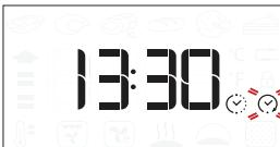
Szükség esetén forgassa el a beállítógombot a sütési idő kívánt végének beállításához, majd nyomja meg az ⏱ gombot a jóváhagyáshoz és a funkció indításához. Helyezze az ételt a sütőbe, és csukja be az ajtót: A funkció automatikusan bekapcsol, amikor letelik a sütés elkészültéhez megadott időpont alapján kiszámított időtartam.
