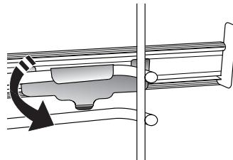
Pentru a fixa ghidajul, apăsați ferm porțiunea inferioară a clemei spre ghidajul pentru grătar. Asigurați-vă că șinele se pot deplasa liber. Repetați acești pași și pentru celălalt ghidaj pentru grătar de la același nivel.
