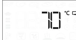
Si la sonde à viande est insérée pendant la sélection d'une fonction, l'écran passe à la température cible par défaut de la sonde à viande.
