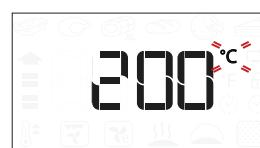
Wenn die Symbole °C/°F auf dem Display blinken, den Knopf drehen, um den Wert zu ändern, anschließend zur Bestätigung drücken und fortfahren, um die nachfolgenden Einstellungen zu ändern (falls möglich).
