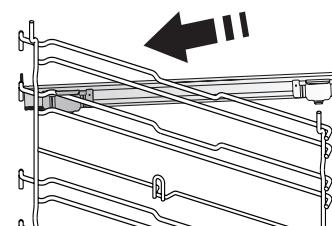
Fixe o encaixe superior da corrediça à guia de nível e faça-a deslizar até parar. Baxe o outro encaixe para o posicionar.
