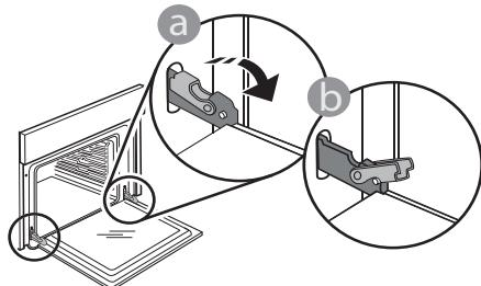
jih še naprej zapirate in jih istočasno nekoliko vlečete navzgor, dokler se ne sprostijo iz vpetja. Odložite vrata na stran in na mehko površino.
