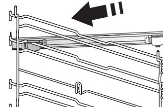
Den oberen Clip des Backauszugs am Seitengitter befestigen und ihn so weit wie möglich entlang gleiten lassen. Den anderen Clip in seine Position absenken.
