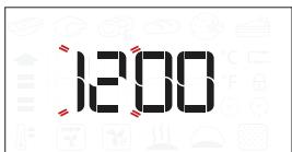
Die beiden Ziffern für die Stunden beginnen zu blinken: Den Knopf drehen, um die Stunden einzustellen und zur Bestätigung drücken.
