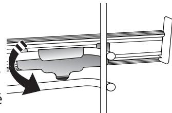
Upozornění: Posuvné drážky lze nainstalovat do kterékoli úrovně.
