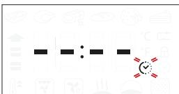
Cuando parpadee el ícono en la pantalla, utilice el selector de ajuste para ajustar el tiempo de cocción necesario y luego pulse para confirmar.
