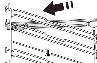
Připevněte horní sponu drážky k vodicí mřížce a suňte ji po celé délce až na doraz. Druhou sponu posuňte směrem dolů, dokud nedosáhne správné polohy.
