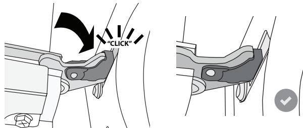
**5.** Zkuste dvířka zavřít a zkontrolujte, zda jsou v jedné rovině s ovládacím panelem. Pokud tomu tak není, výše uvedený postup opakujte: Pokud dvířka správně nefungují, mohou se poškodit.
