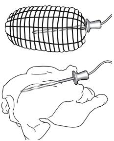
De correcte plaatsing van de thermometer is belangrijk om het gewenste bereidingsresultaat te kunnen bereiken. Steek de thermometer volledig in het malste gedeelte van het stuk vlees, zonder daarbij botten of vette gedeelten te raken. Voor gevogelte moet de thermometer dwars, in het midden van de borst, geplaatst worden, waarbij u er op moet letten dat de punt niet in een holle ruimte terecht komt.
