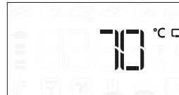
Če je sonda za meso nameščena, medtem ko izbirate funkcijo, se na prikazovalniku pojavi prevzeta ciljna temperatura sonde mesa.
