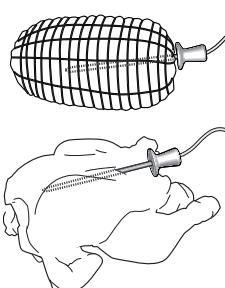
Posiționarea corectă a sondei este extrem de importantă pentru obținerea unor rezultate de preparare perfecte. Introduceți complet sonda în carne, evitând zonele osoase și părțile cu grăsimi. Pentru carne de pasăre, sonda trebuie introdusă pe diagonală, în partea din mijloc a pieptului, având grijă ca vârful să nu ajungă într-o porțiune goală. Dacă gătiți o bucătă de carne cu grosime neregulată, verificați ca aceasta să
