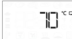
Wenn der Kerntemperaturfühler während der Auswahl einer Funktion eingesteckt wird, wechselt das Display zur Standard-Zieltemperatur des Kerntemperaturfühlers. Drücken Sie zum Starten des Einstellvorgangs. Drehen Sie den Knopf zum Einstellen der Zieltemperatur für den Kerntemperaturfühler. Zur Bestätigung drücken Sie . Drehen Sie den Knopf zum Einstellen der gewünschten
