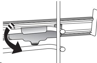
Para fixar a guia, pressione a parte inferior do dispositivo de fixação firmemente contra a guia de nível. Assegure-se de que as corrediças se movem livremente. Repita estes procedimentos para a outra guia de nível, no mesmo nível.
