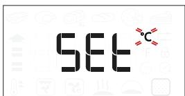
Den Auswahlknopf zur Auswahl der Maßeinheit drehen, anschließend zur Bestätigung drücken.
