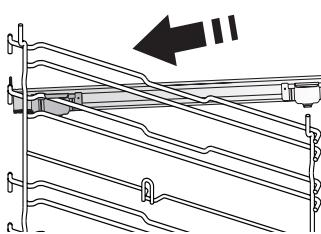
Iz pečice umaknite vodila za pekače in z drsnih vodil odstranite plastično zaščito.
