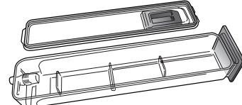
2. Uma vez terminada a limpeza, pode fechar a gaveta inserindo as duas abas frontais nas aberturas frontais e empurrando a parte de trás para baixo.
