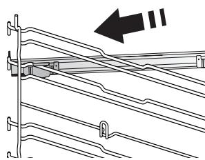
Retire as guias de nível do forno e remova o plástico de proteção das corrediças.
