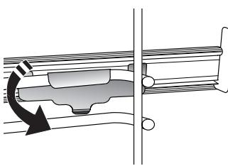
Da vodila zavarujete, spodnji del sponke čvrsto pritisnite na vodila za pekače. Prepričajte se, da je mogoče drsna vodila nemoteno premakniti. Postopek ponovite na drugem vodilu za pekače, ki je na enaki višini.
