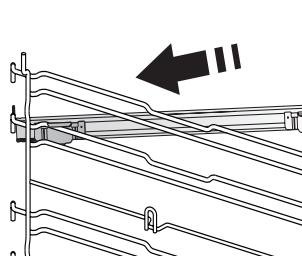
Uklonite vodilice rešetki iz pećnice i uklonite zaštitnu plastiku s kliznih vodilica.
