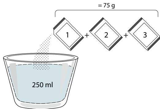
Una vez añadida la solución de desincrustación al cajón, pulse ▶ para iniciar el proceso de desincrustación principal. Durante las distintas fases de la desincrustación, no es necesario que preste atención al aparato. Una vez completada cada una de las fases, sonará un aviso acústico y aparecerán en la pantalla instrucciones para pasar a la siguiente fase.
