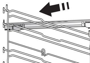
Vyberte vodiace lišty z rúry a z posuvných bežcov odstráňte ochranné plasty. Pripevnite vrchnú svorku bežca na vodiaci lištu a nasuňte, pokiaľ to ide. Druhú svorku spustite na miesto.
