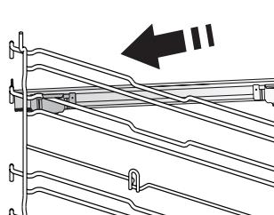
Demontați ghidajele pentru grătar din cuptor și îndepărtați folia protectoare din plastic de pe șinele culisante.
