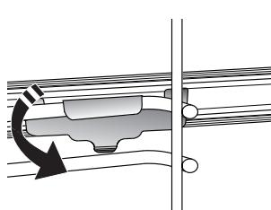
Vodilicu učvrstite tako da čvrsto pritisnete donji dio kopče na vodilicu rešetke. Provjerite mogu li se vodilice slobodno pomicati. Ove korake ponovite na drugoj vodilici rešetke na istoj razini.
