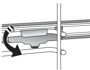
Aby byla vodicí mřížka dobře zajištěna, zatlačte pevně spodní část spony oproti vodicí mřížce. Ujistěte se, že drážkami lze volně pohybovat. Postupujte stejně i na druhé straně vodicí mřížky v rámci stejné výškové úrovně.
