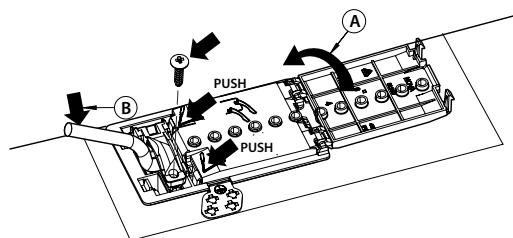
**Spotrebič musí byť pripojený k zdroju napájania prostredníctvom viacpólového spínača s minimálnou vzdialenosťou medzi kontaktmi 3 mm.**
