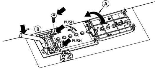
Bei der Installation muss ein allpoliger Trennschalter mit einer Kontaktöffnungsweite von mindestens 3 mm vorgesehen werden, mit dem das Gerät spannungslos gemacht werden kann.
