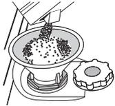
1. Ziehen Sie den Unterkorb heraus und schrauben Sie den Salzbehälterdeckel gegen den Uhrzeigersinn ab.
